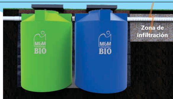
1. Cavar un pozo con espacio suficiente para ubicar las dos cámaras y sus conexiones. Se recomienda una superficie no menor a 1,50 m x 3,60 m. La profundidad debe ser suficiente para que la entrada (referencia en el gráfico) pueda conectarse con el caño que trae el agua cloacal de la casa. Hasta allí la pendiente es de 1cm/metro (imagen de la pendiente)
