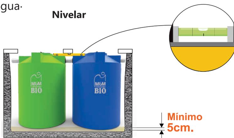
5. Rellenar el espacio comprendido entre los módulos y el terreno con hormigón liviano o suelo cemento (mezcla de tierra y cemento) hasta cubrir las conexiones entre los módulos.
