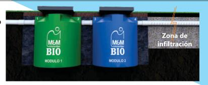
1. Cavar un pozo con espacio suficiente para ubicar las dos cámaras y sus conexiones. Se recomienda una superficie no menor a 1,20 m x 2,40 m. La profundidad debe ser suficiente para que la entrada (referencia en el gráfico) pueda conectarse con el caño que trae el agua cloacal de la casa. Hasta allí la pendiente es de 1cm/metro (imagen de la pendiente)
