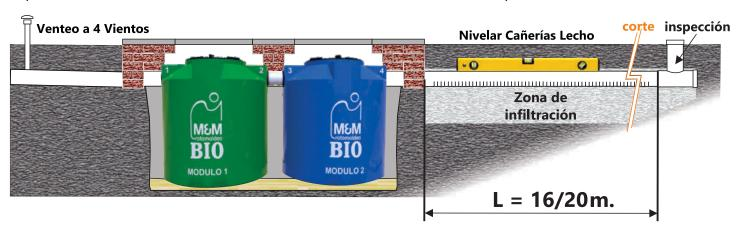
Se aconseja colocar una inspección en un extremo del lecho, colocando una pieza "T", con un tramo hasta alcanzar nivel cero con tapa y venteo a los 4 vientos en la cañería de desagüe hacia el equipo (esta solo deberá contemplarse si la instalación de desagüe de la vivienda no contara con ventilación).
